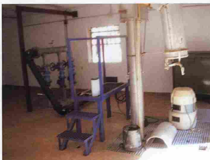
Imagen 15: Estructura de acceso al tamiz actual. Fuente: Elaboración propia
